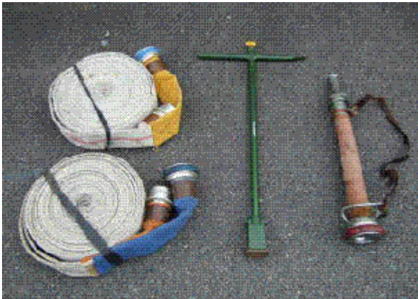
二重巻きホース・消火栓キー・筒先(管そう) (メス金具が外に来るように巻いておく事)
